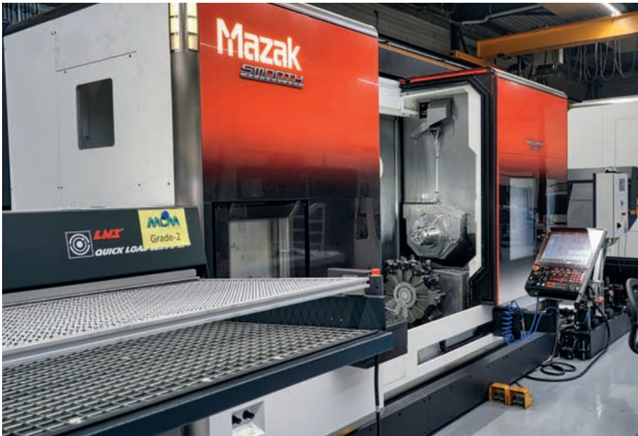
De nieuwe Mazak Integrex i-250H ST bij MCM is voorzien van automatische stafaanvoer. Wellicht komt er in de toekomst nog een robot bij.
